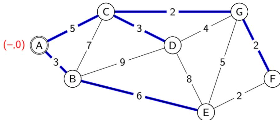
Verfolgt man gemäss den Knotenbeschriftungen die Pfade von den einzelnen Knoten zurück, erhält man einen *Spannbaum*. Dieser Baum enthält jeden Knoten des Graphen und die Summe der Kantengewichte vom Wurzelknoten (A) bis zum jeweiligen Knoten ist minimal. *Beispiel*: Der kürzteste Weg von (A) nach (F) geht über (C) und (G).
