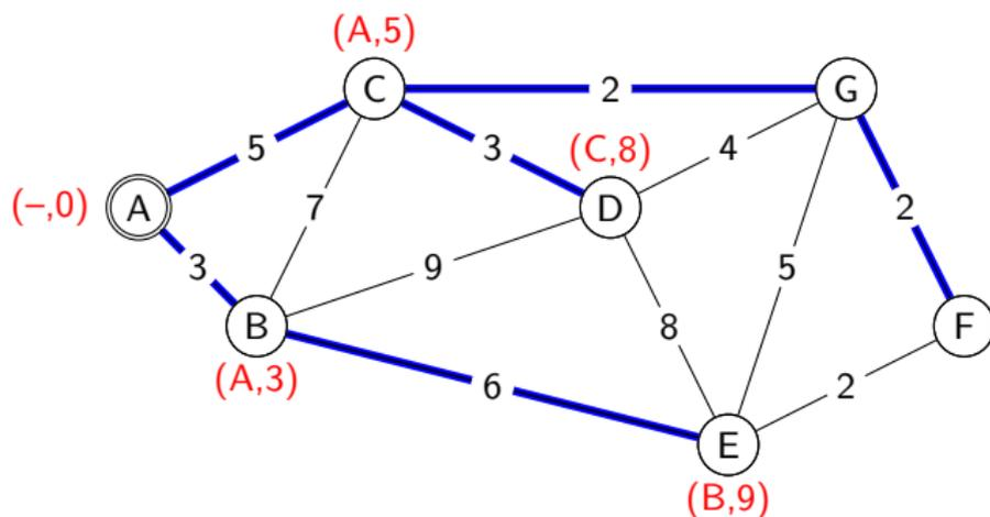
Verfolgt man gemäss den Knotenbeschriftungen die Pfade von den einzelnen Knoten zurück, erhält man einen *Spannbaum*. Dieser Baum enthält jeden Knoten des Graphen und die Summe der Kantengewichte vom Wurzelknoten (A) bis zum jeweiligen Knoten ist minimal. *Beispiel*: Der kürzteste Weg von (A) nach (F) geht über (C) und (G).
