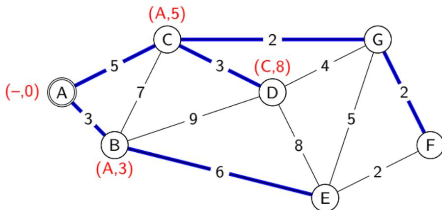
Verfolgt man gemäss den Knotenbeschriftungen die Pfade von den einzelnen Knoten zurück, erhält man einen *Spannbaum*. Dieser Baum enthält jeden Knoten des Graphen und die Summe der Kantengewichte vom Wurzelknoten (A) bis zum jeweiligen Knoten ist minimal. *Beispiel*: Der kürzteste Weg von (A) nach (F) geht über (C) und (G).
