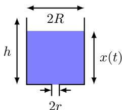
Die momentane Höhe  $x$  des Wasserspiegels in Abhängigkeit von der Zeit  $t$  erfüllt die Differentialgleichung
